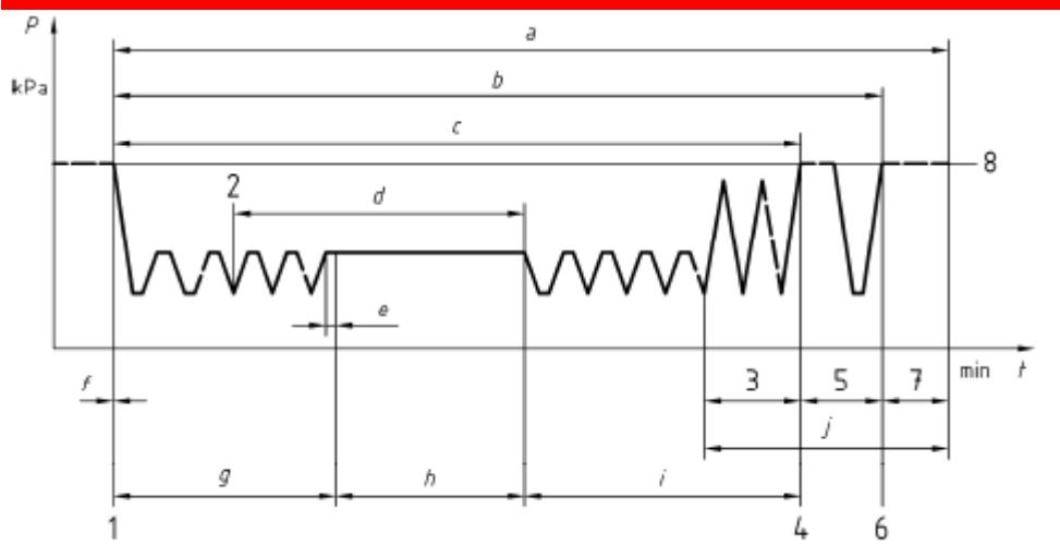
图1 低温蒸汽甲醛灭菌全过程
